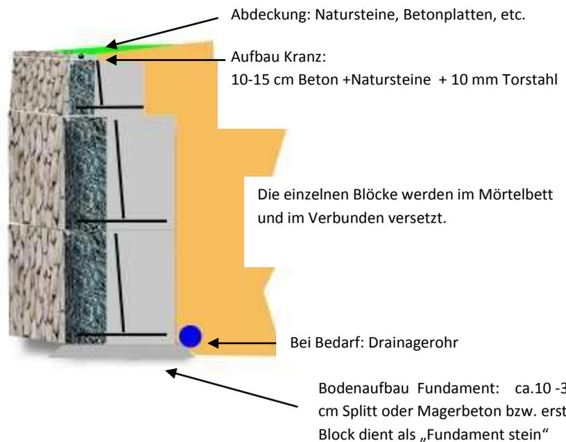
Nach dem Versetzen wird der Kranz hergestellt. Anschließend werden die senkrechten Spalten mit Betonmörtel und Steinen verfügt.
